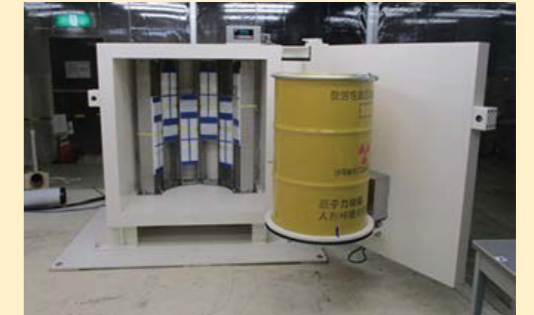
金属容器中のウラン量測定装置
